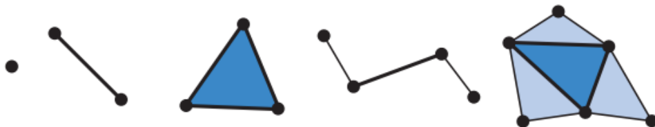
图 3.12: 几何着色器的输入是一些简单类型：点、线段、三角形。最右边的两个图元包含了与线段和三角形相邻的顶点。也可以使用一些更加复杂的面片类型。
